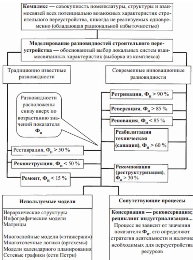
Рисунок 1 – Инфографическая модель видов строительного переустройства
