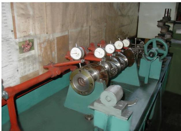
Рисунок 1 – Индикаторный стенд для измерения радиального биения фланца КВ, средних коренных шеек и шейки под распределительную шестерню относительно крайних коренных шеек
