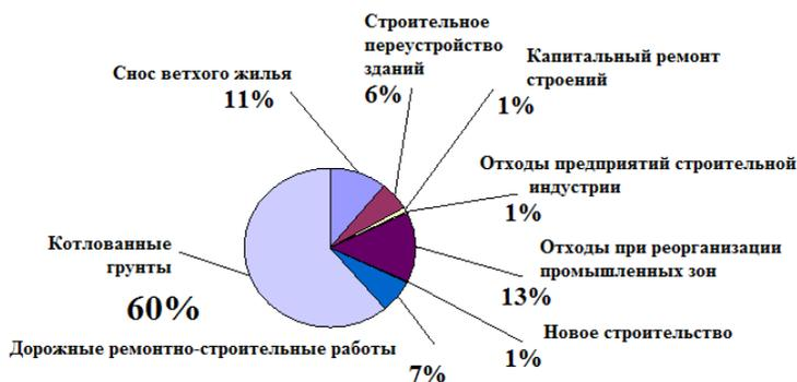
Рисунок 2 – Распределение котлованных грунтов по источникам их образования, %
